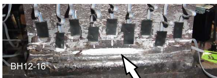
梁フランジ中央の溶接止端部から延性亀裂が進展
